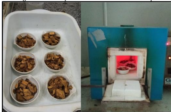
Figura 9: Fabricação do carvão ativado do endocarpo.
