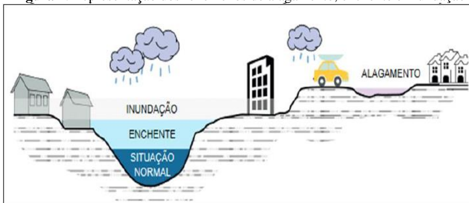
Figura 2. Representação dos fenômenos de alagamento, enchente e inundação
